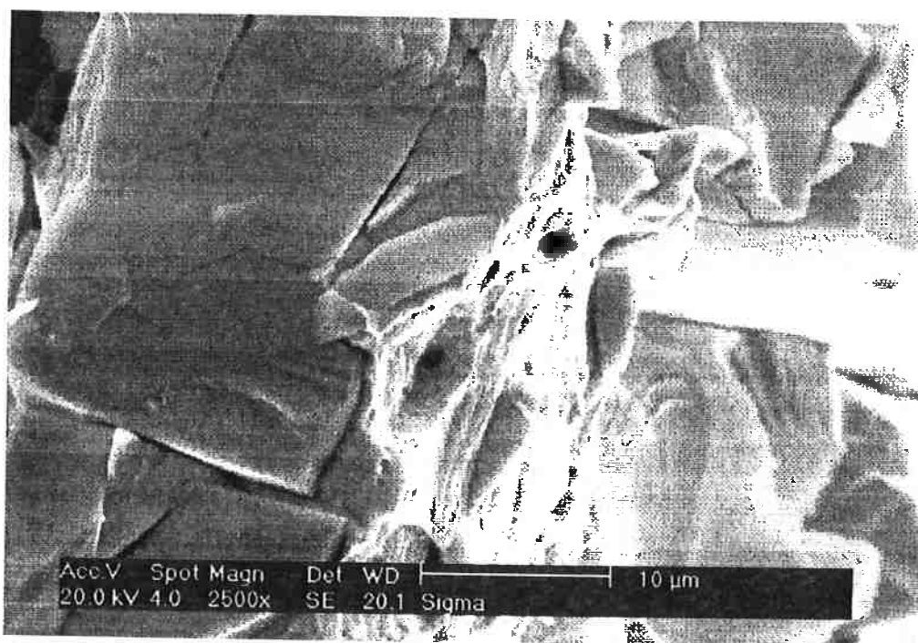
Figura 15: Amostra A (850°C por 94h), ataque V2A, aumento de 2500x, microscopia eletrônica de varredura com elétrons secundários. Vista frontal (plano Y, vide figura 1).
